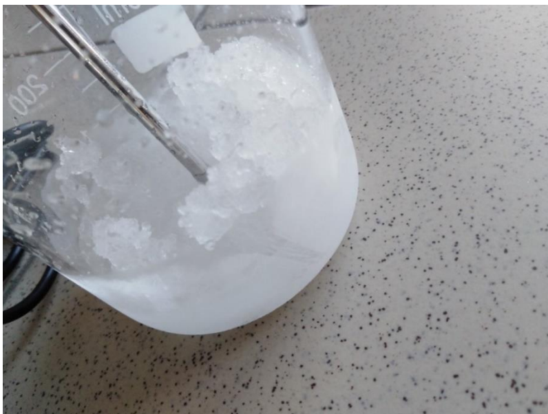
Foto 3: Detail měření směsi ledové tříště a soli (Autor: V. Machková)
