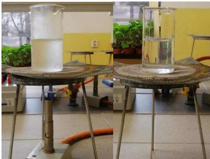
Foto 4: Vlevo: Studená kádinka se studenou vodou pár sekund po zahřívání. Vpravo: Studená kádinkou se studenou vodou (Autor: M. Bělochová)
